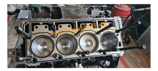
Natürlich muss die Oberflächenrauheit von Zylinderkopf und Motorblock passen für eine optimale Abdichtung. Auch das prüfen wir immer:
